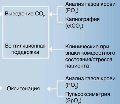
Обычные аппараты ИВЛ настраиваются вручную, и врач должен постоянно оценивать их работу. ASV позволяет автоматизировать этот процесс путем использования управления с замкнутым контуром, благодаря чему этот режим является первым в мире режимом «Интеллектуальной Вентиляции».
