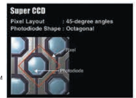
Миниатюрная ПЗС-матрица Super CCD Honeycomb
