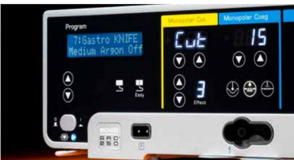
Функция GastroCut KNIFE предназначена для рассечения с помощью папиллотома или электродами-иглами
