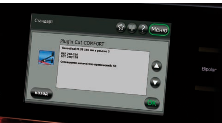
Plug'n Cut COMFORT: система COMFORT автоматически распознает инструмент, информирует о том, сколько раз может быть еще применен этот инструмент и выбирает параметры, необходимые для цели применения.
