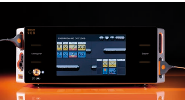
Понятность: каждый подключенный разъем – на изображении верхний левый и нижний правый разъемы – соотнесен с одним квадрантом экрана
